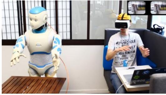
Figure 3 : Téléopération immersive du robot ROMEO
