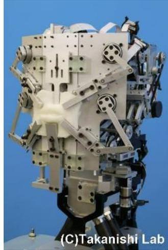
Figure 28 : Photo du robot Waseda Talker (modèle WT-7R11)
