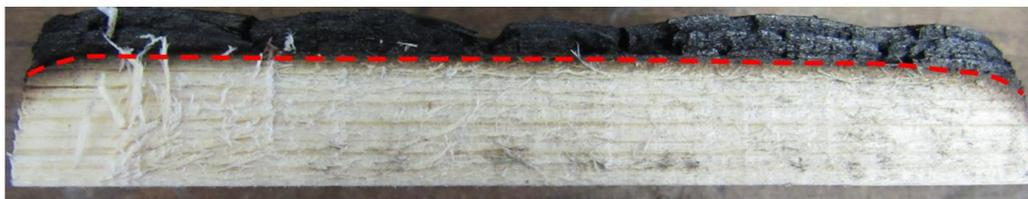
b. Coupe au centre d'un échantillon soumis à  $50 \text{ kW.m}^{-2}$  pendant 700 secondes
