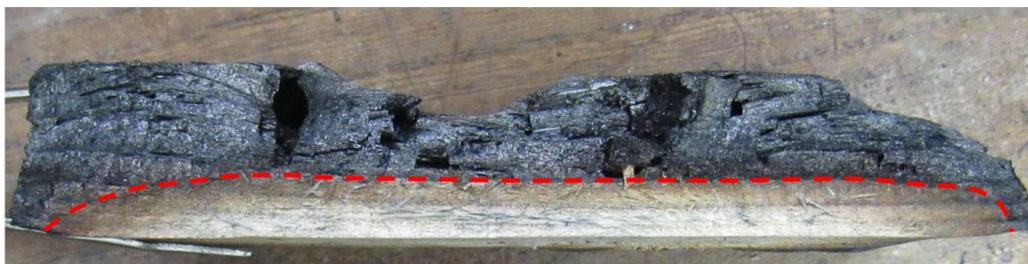
Figure 3-15 : Front de pyrolyse pour un flux de  $50 \text{ kW.m}^{-2}$ , a. Après une exposition de 200 secondes, b. Après une exposition de 700 secondes<sup>1</sup>
