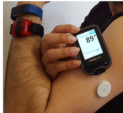
FIGURE 3.2: Capteur et lecteur FreeStyle Libre (gauche) et leur utilisation (droite).
