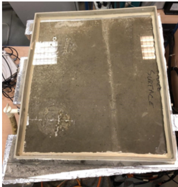
FIGURE 5.9 – Vue de la dalle FV posée au sol, face soumise à l'imbibition découverte et munie du bac d'imbibition retenant l'eau en surface.
