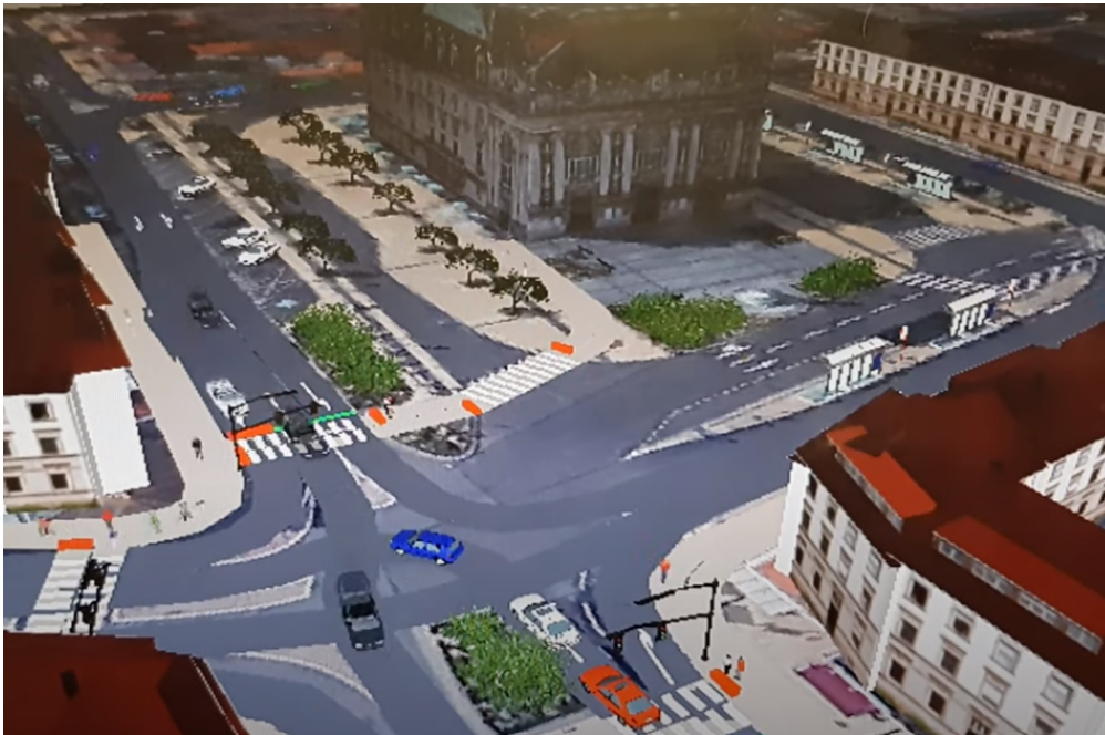
FIGURE 2.1 – Simulation microscopique multi-agents des véhicules motorisés, des piétons et des feux de signalisation dans un quartier de Calais. La simulation est réalisée avec le simulateur Vissim [157].
