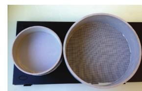
**FIGURE B.1** – tamis à mailles de 10 µm et 1 mm
