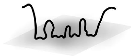
Figure 8 : Polymère adsorbé sur une surface. Notez les nombreux points d'accroche. Tiré de 138 .
