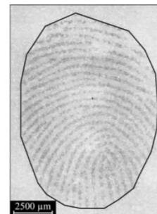
Figure 1.22 : Empreinte observée au microscope optique numérique (Keyence VH-ZST). La ligne brisée noire autour de l'empreinte correspond au contour utilisé dans la mesure de l'aire apparente de contact. .
