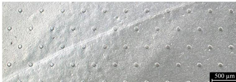
Figure 2.14 : Défaut apparaissant sur le moule puis sur les répliques lors d'un démoulage trop rapide.
