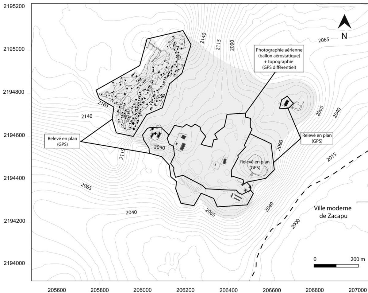
**Figure 41 : Cartographie des opérations de relevés menées en 2010 sur le site de El Palacio. Les points de ces relevés ont été complétés par des points issus des cartes de l'INEGI et de Google Earth afin d'obtenir les courbes de niveaux et le modèle numérique de terrain de cet établissement.**
