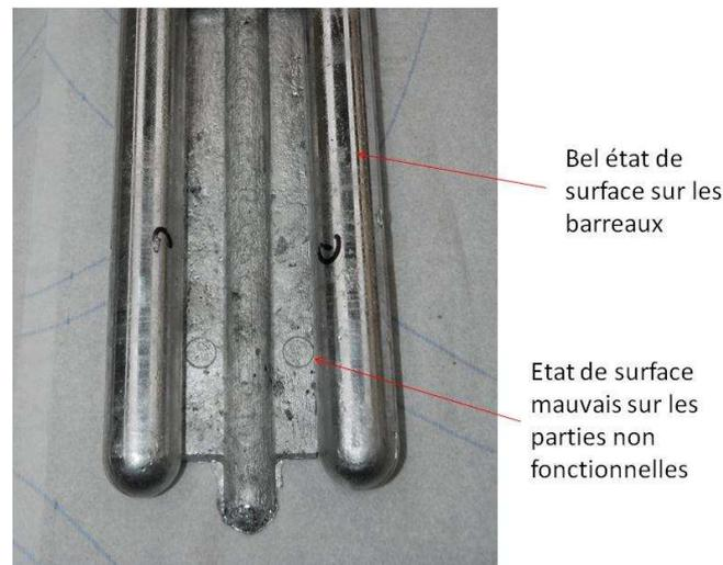
Figure 3-47 : Barreaux de coulée obtenus avec le moule n°2
