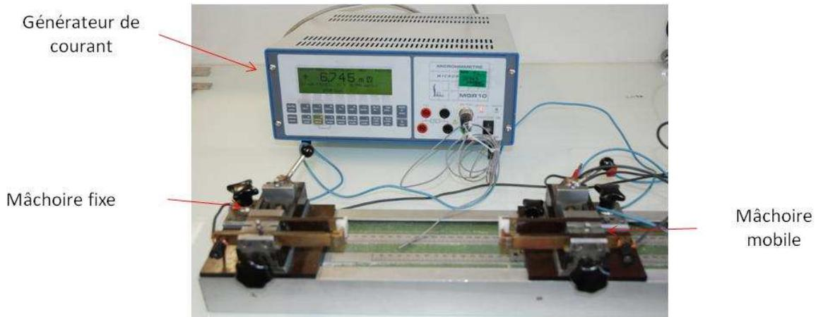
Figure 6-1 : Banc de mesure de résistance
