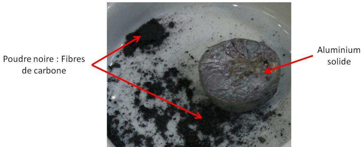
Figure 3-8 : Fibres de carbone non intégrées à l'aluminium
