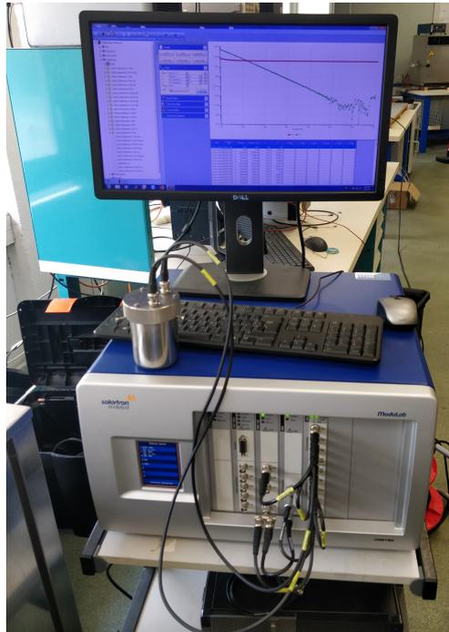
Figure 2.2: Spectroscopie diélectrique Solartron Analytical Modulab MTS couplé à une cellule de mesure type IRLAB CL-1
