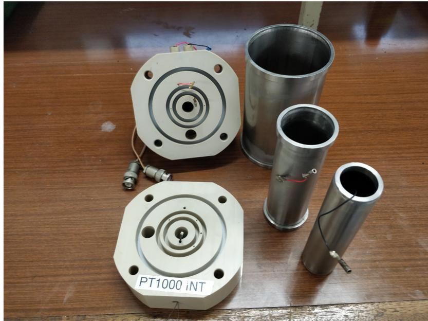
Figure 4.3: Éléments de la cellule de mesure (flasques, électrodes, connexions)
