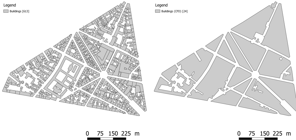
FIGURE 3.6 – Représentation du secteur de la Place de Mexico à Paris en : (a) un plan masse à 613 empreintes de bâtiments, (b) une maquette simplifiée à 24 empreintes de blocs.
