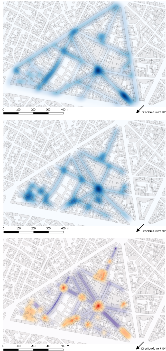
FIGURE 3.12 – (a) Carte de chaleur de la vitesse de vent moyenne pour les 32915 capteurs aérauliques, (b) Carte de chaleur de \overline{v_{vide}} pour les 900 capteurs morphologiques, (c) Superposition des 14 cartes de chaleur morphologiques pour les indicateurs corrélés à \overline{v_{canal}} (en mauve) et \overline{v_{collec}} (en orange).
