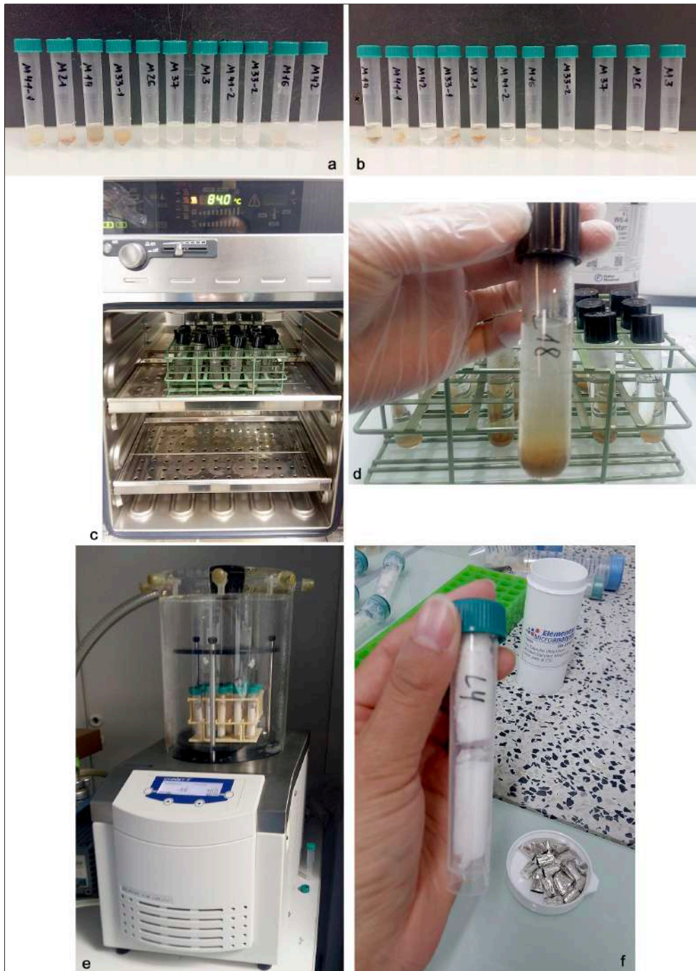
Figure 83. Les étapes de la préparation de l'extraction du collagène osseux : a) les échantillons dans une solution du méthanol et chloroforme ; b) après le nettoyage dans l'agitateur basculant ; c) solubilisation de l'échantillon dans une étuve à environ 90°C ; d) l'échantillon dissous avant la filtration ; e) l'échantillon mis au lyophilisateur après la filtration et la congélation ; f) le collagène prêt (© L. Romanova).
