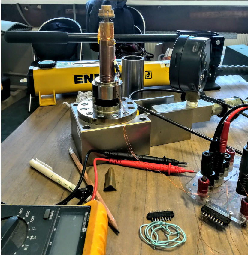
FIGURE 2.13 – Application de la pression dans la cellule EasyLab ® à l'aide d'un vérin hydraulique (en arrière plan en jaune).
