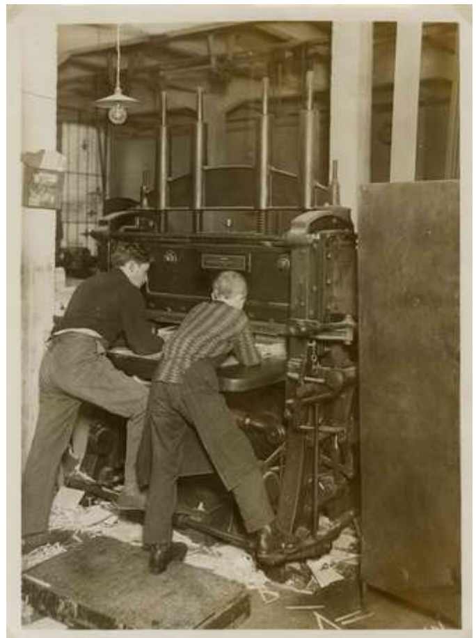
6. Deux ouvriers actionnent une rogneuse « Krause »
