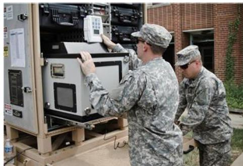
**Figure I- 26 Photographie du GC/MS Griffin 460 lors d'une investigation sur le terrain.**
