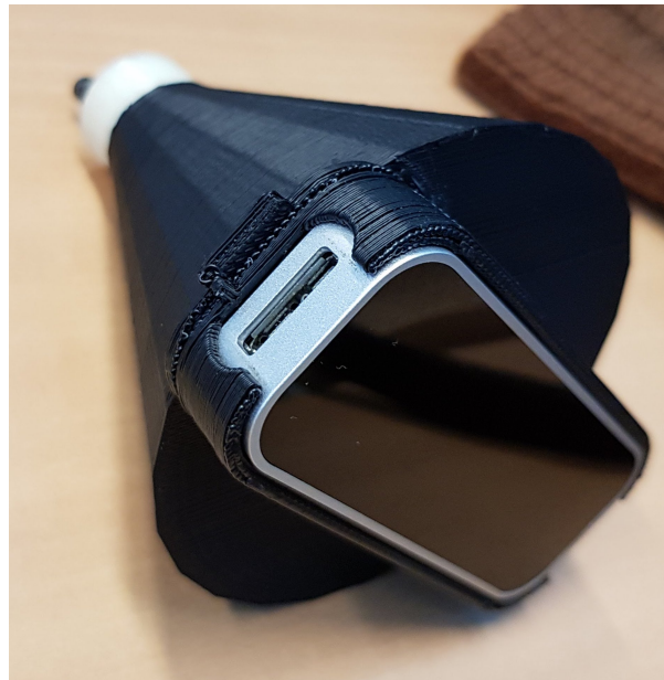
FIGURE 3.6 – Support réalisé par impression 3D permettant de fixer le Leap Motion© à une lampe
