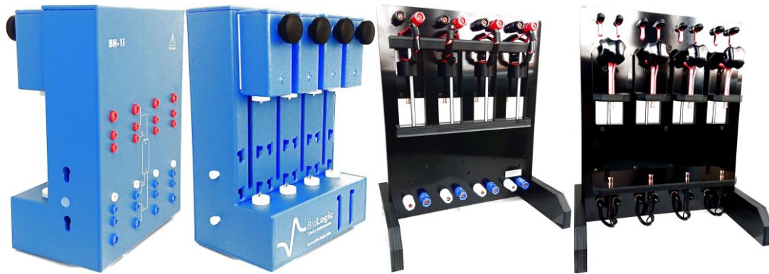
Fig. 2.3 Supports utilisés pour la mesure 4-fils des cellules.
