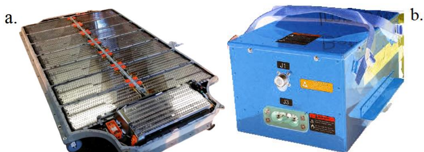
Fig. 1.15 Exemple de packs de Tesla Model S (a) et du Boeing 787 Dreamliner (b).
