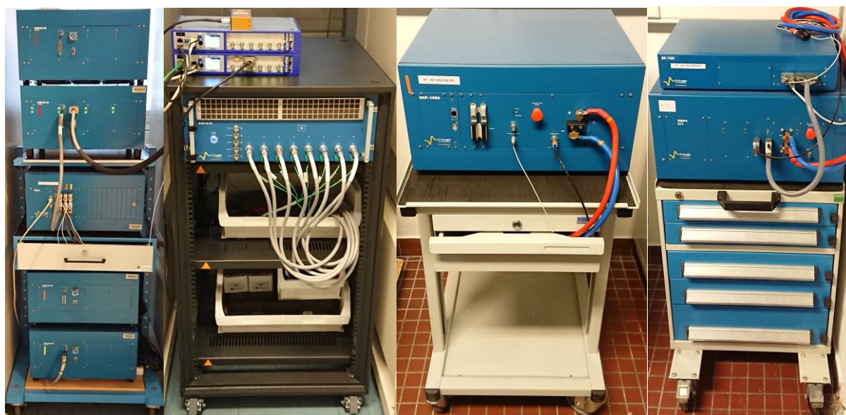
Fig. 2.2 Potentiostats, dans l'ordre : VMP-3 et ses boosters, BCS-815, HCP-1005 et SP-150.
