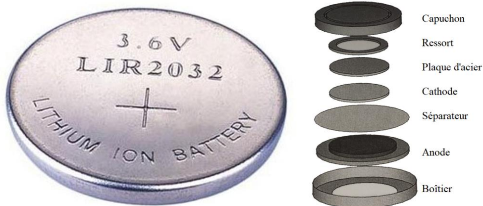
Fig. 1.8 Cellule bouton [44] .
