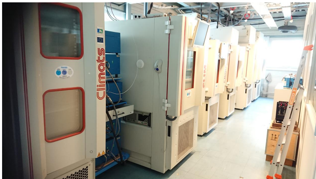
Fig. 2.1 Salle des essais, constituée de six enceintes Climats et de multiples potentiostats.
