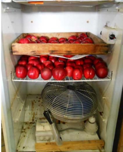
Figure 31 : Enceinte ventilée avec un appareil de mesure de la température et de l'humidité pour mesurer la conductance cuticulaire des fruits.
