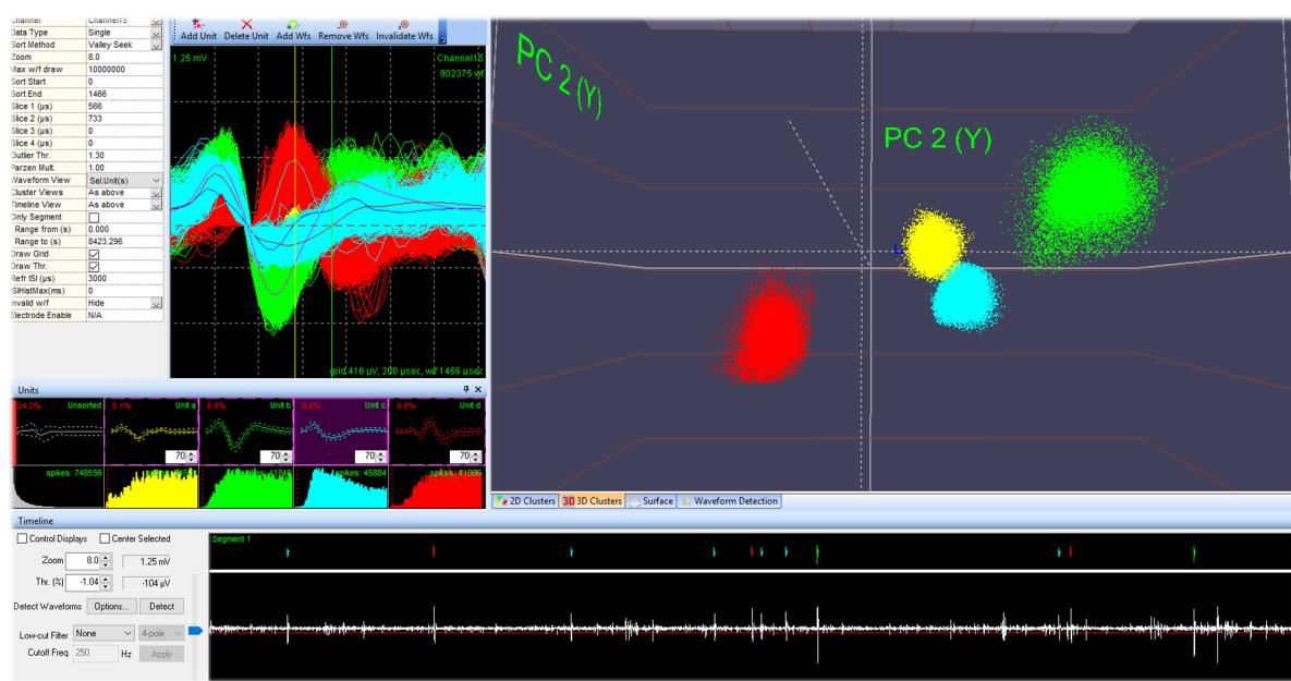
**FIGURE.32 :** Capture d'écran du logiciel OfflineSorter. Séparation de l'activité de 4 neurones différents enregistrés sur une même électrode (tracé en bas). Chaque nuage de points (rouge, jaune, vert et bleu en haut à droite) représente l'ensemble des potentiels d'actions des 4 neurones, regroupés par analyse en composantes principales.
