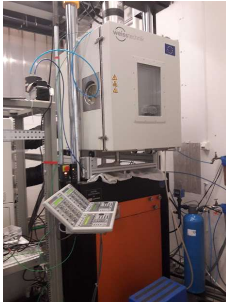
Figure 2-10 : Photo de la machine biaxiale Instron 1343 équipée d'une enceinte de contrôle de température et d'hygrométrie
