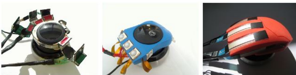
FIGURE 5.2 – Différents prototypes initiaux du HandNavigator, appelés de gauche à droite V2, V3t et V3s.
