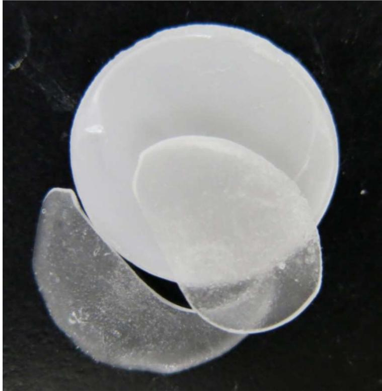
*Figure 34 : Photographie d'un échantillon fracturé (VM7/Y-TZP). L'armature zircone est en arrière-plan, encore recouverte d'une couche d'émaillage. Deux fragments de céramique se sont détachés au premier plan.*
