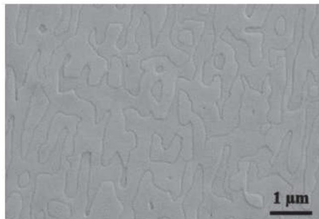
Figure 28 : Présence des parois d'antiphase à la surface d'une couche GaAs/Si présentée sous forme d'une image MEB
