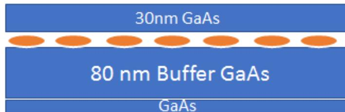
Figure 88 : Structure réalisée sur substrat GaAs à 480°C
