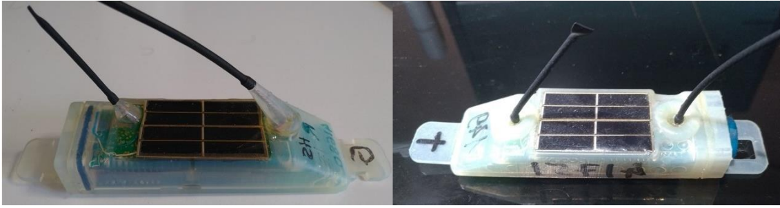
Figure 27 : Première génération (gauche) et deuxième génération (droite) des XArgos posées à perte » sur des individus non reproducteurs.
