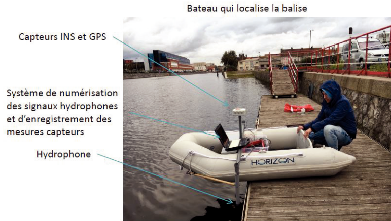
FIGURE 1.20 – Système de réception du Laboratoire [10]
