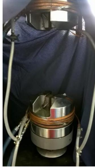
Figure 94 : Système de refroidissement des mors
