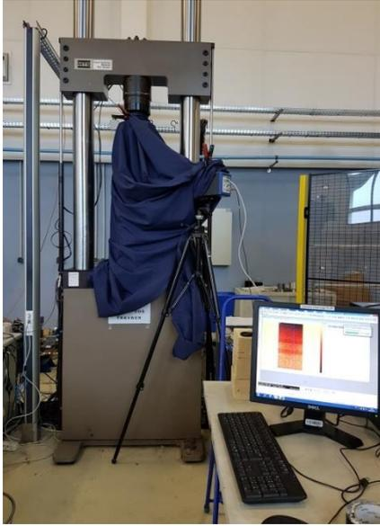
Figure 93 : Positionnement de la caméra devant la machine de traction
