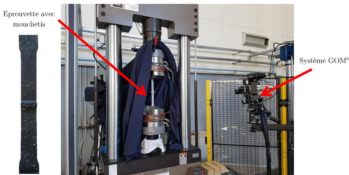
**Figure 78: Positionnement du système GOM<sup>®</sup> de stéréo-corrélation d'images**
