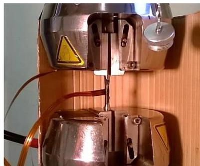
Figure 57 : Photo du montage avec 3 thermocouples
