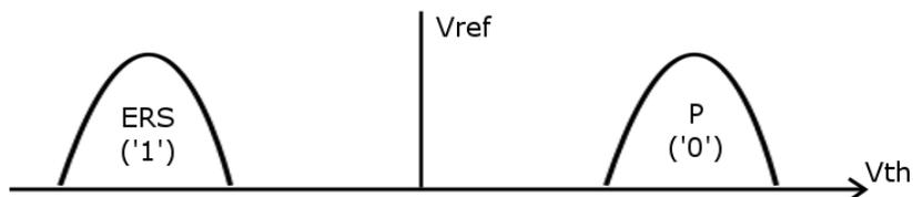
Figure 21 : Distribution théorique des tensions de seuil des cellules mémoires SLC
