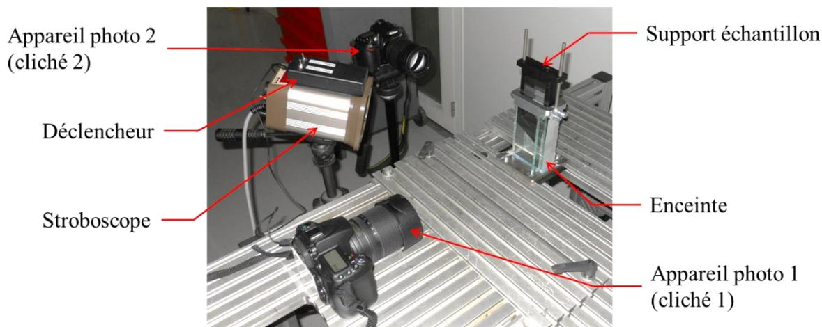
Figure IV- 12 : Dispositif expérimental utilisé pour la réalisation des essais de validation.
