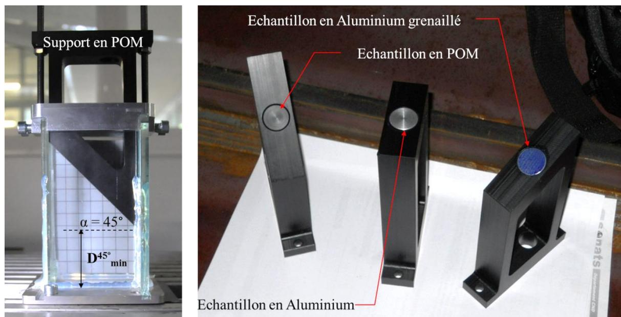
Figure IV- 11 : Vu d'ensemble de l'enceinte de grenailage et des supports échantillon : a) montage avec le support à 45°, b) les trois portes échantillon 45°, 0°, 20° (dans l'ordre) contenant respectivement un échantillon en POM, en aluminium avant traitement et en aluminium grenailé (MER).
