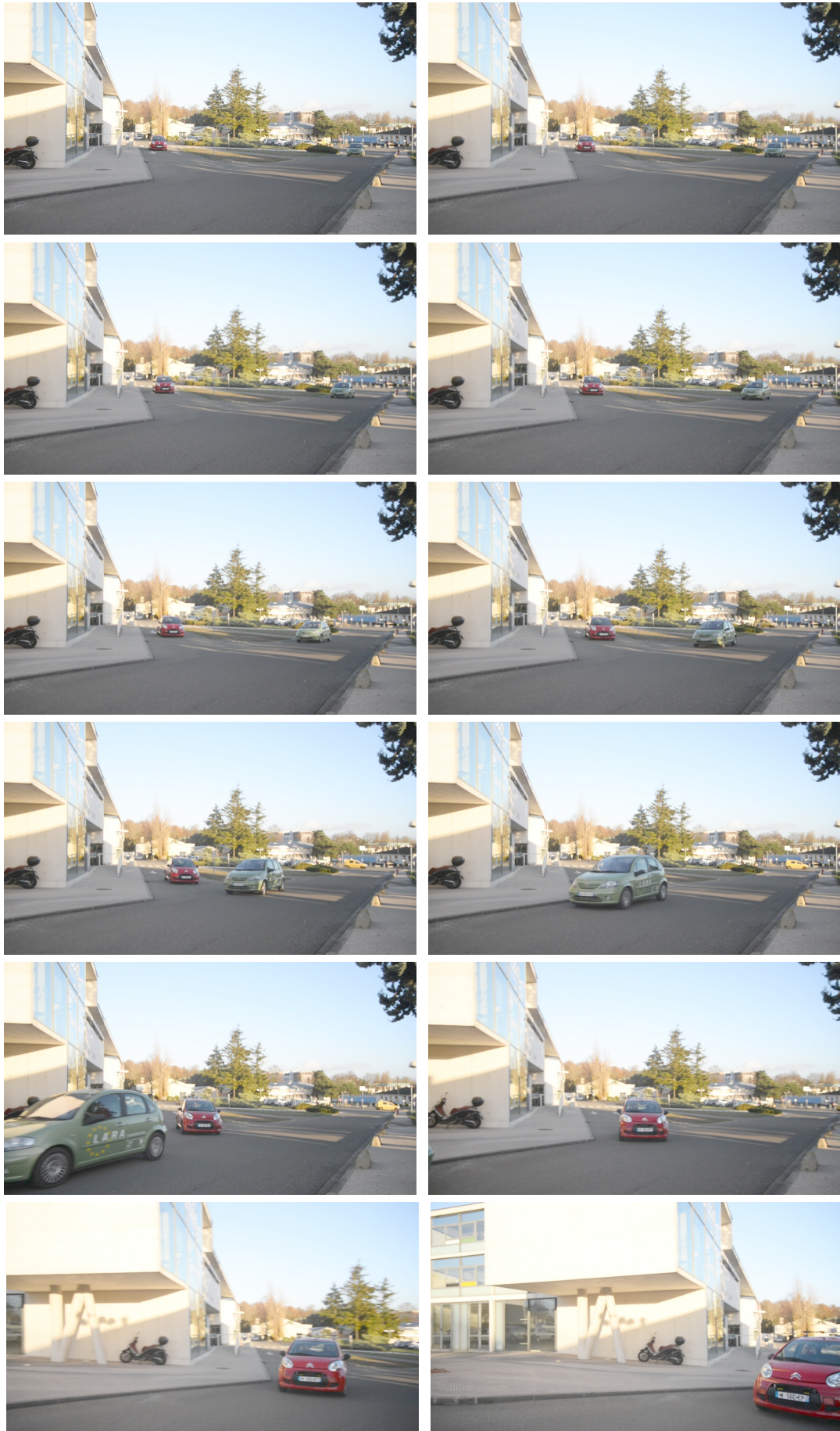
FIGURE 2.45 – Décision de céder le passage avec un seuil de TG agressif. La C1 rouge (ego) cède le passage à la C3 verte, en ne laissant qu'un faible délai entre les deux véhicules. Le TG mesuré entre les trajectoires est de -1,15 s. L'écart entre 2 images successives est de 0,5 s.
