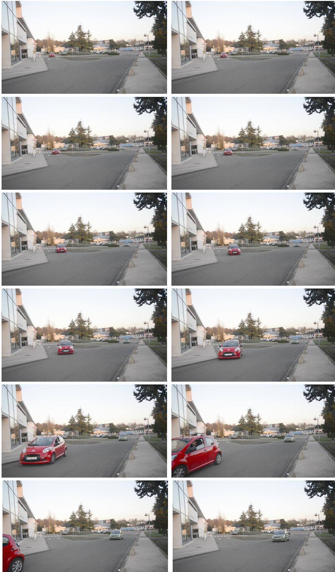
FIGURE 2.44 – Décision de s'engager en situation réelle. La C1 rouge (ego) prend le virage à 4,2 m/s et s'insère 11,8 m devant la C3 verte qui circule à 9,4 m/s. Le TG mesuré entre les deux trajectoires est de 2,16 s. L'écart entre 2 images successives est de 0,5 s.
