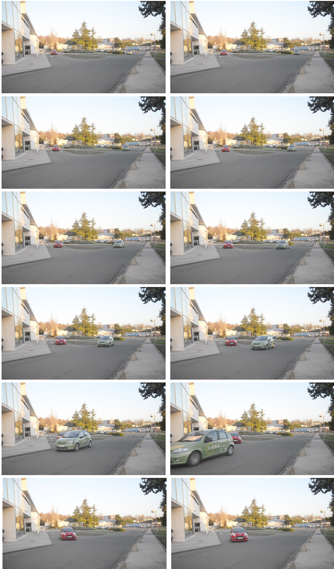
FIGURE 2.43 – Décision de céder le passage en situation réelle. La C1 rouge (ego) ralentit à 3,4 m/s pour céder le passage à la C3 verte qui circule à 8,6 m/s. Le TG mesuré entre les deux trajectoires est de -2,25 s. L'écart entre 2 images successives sur la séquence est de 0,5 s.
