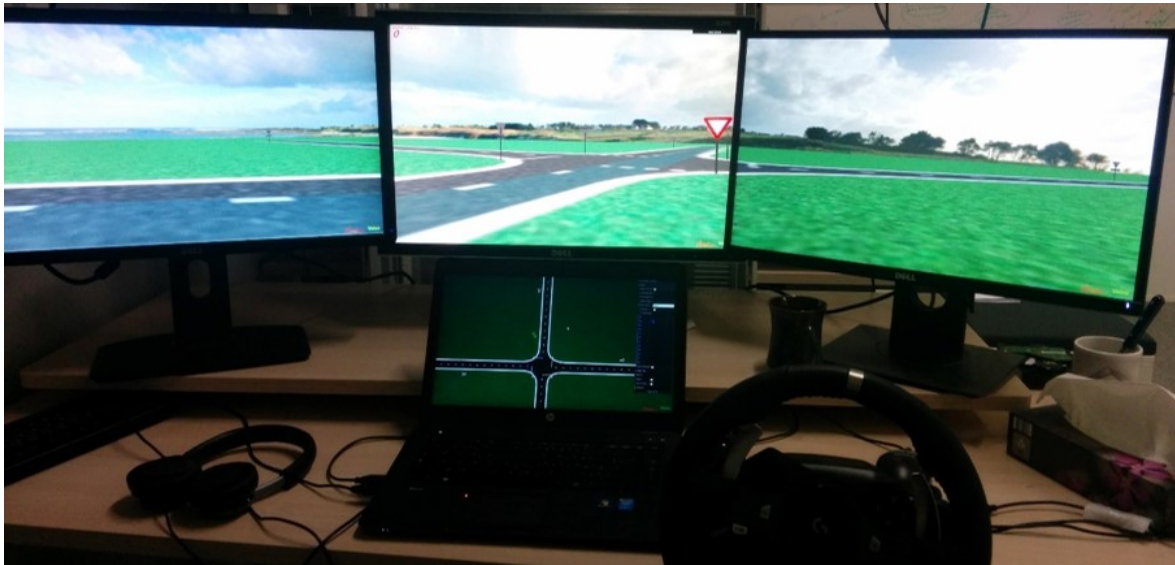
FIGURE 2.5 – Poste de conduite en simulation avec vue sur 3 écrans. Des pédales ainsi qu'un volant USB sont utilisés pour la conduite.
