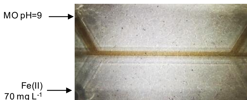
Figure IV-3 – Circuit micro-fluidique utilisé pour la synthèse d'agrégats Fe-MO en laboratoire.
