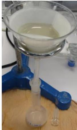
**Figure 114 : Dispositif de filtration pour les particules supérieures à 100  $\mu\text{m}$ .**
