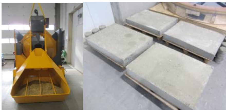
Figure 106 : Camion toupie utilisée lors du malaxage (gauche). Dalles en béton pendant le stockage.
