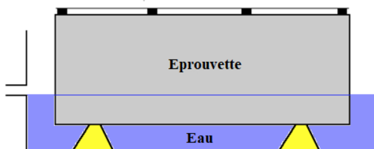
Figure 113 : Dispositif de l'essai NF EN 15148[98]
