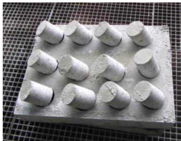
Figure 108 : Carottage des dallettes.
