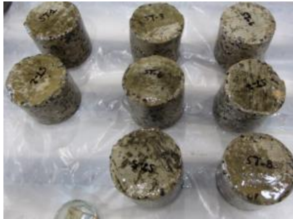
Figure 111 : État de surface des éprouvettes après le résinage époxy.
