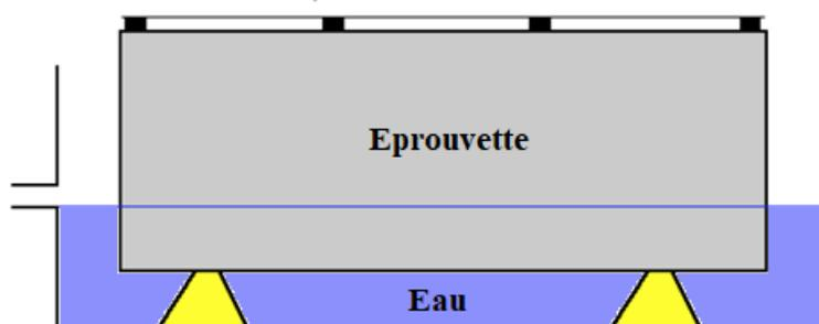
**Figure 113 : Dispositif de l'essai NF EN 15148[98]**
