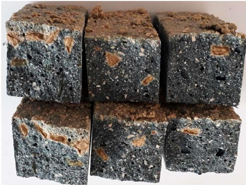
*Figure IV-6 Photographie des éprouvettes avec substitution à 100% par le « sol 1 » après rupture mécanique*
