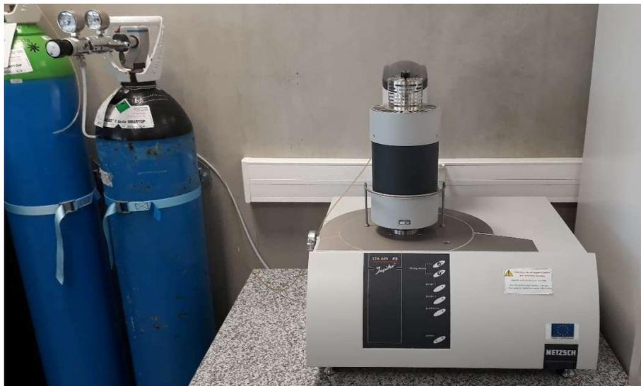
Figure II-8 Dispositif d'Analyse Thermo-Gravimétrique
