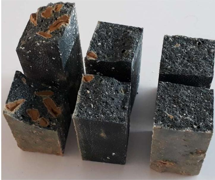
*Figure IV-5 Photographie des éprouvettes avec substitution à 50% par le « sol 1 » après essais de flexion 3 points*
