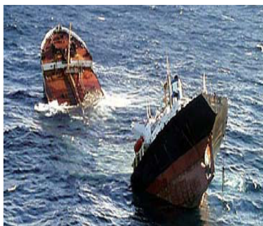
FIGURE 1.3 – Rupture de la structure du pétrolier “Prestige” suite à une tempête en novembre 2002 ( http://www.hydrolance.net ).
