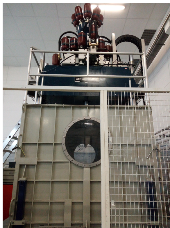
FIGURE 5.1 – Photographie de la maquette de section d'étrave suspendue au piston de la machine choc (à gauche) et photographie du dispositif expérimental avec la cuve (à droite).
