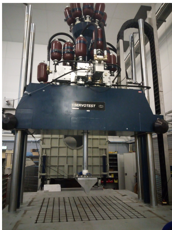
FIGURE 5.1 – Photographie de la maquette de section d'étrave suspendue au piston de la machine choc (à gauche) et photographie du dispositif expérimental avec la cuve (à droite).
