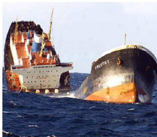
FIGURE 1.3 – Rupture de la structure du pétrolier “Prestige” suite à une tempête en novembre 2002 ( http://www.hydrolance.net ).
