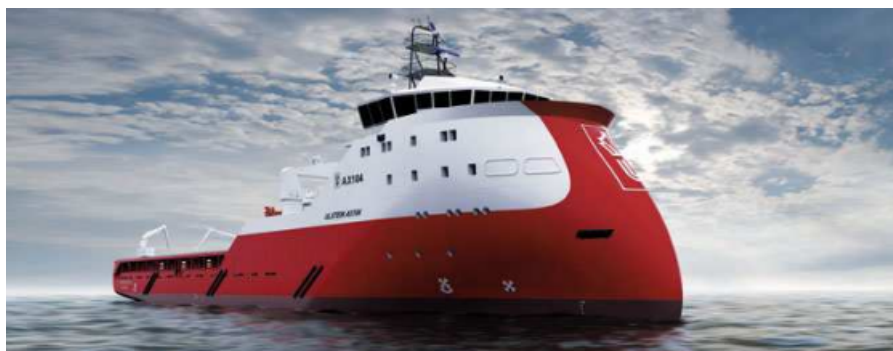
FIGURE 1.4 – Concept d'étrave X-bow pour réduire les effets du slamming ( http://www.ulsteingroup.com ).
