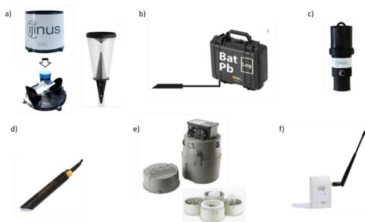
Figure 25: Image des équipements installés : a) le pluviomètre à auget et le pluviomètre standard, b) le capteur hauteur-vitesse, c) le piézomètre, d) le turbidimètre, e) préleveur automatique, f) le capteur de radiofréquence.
