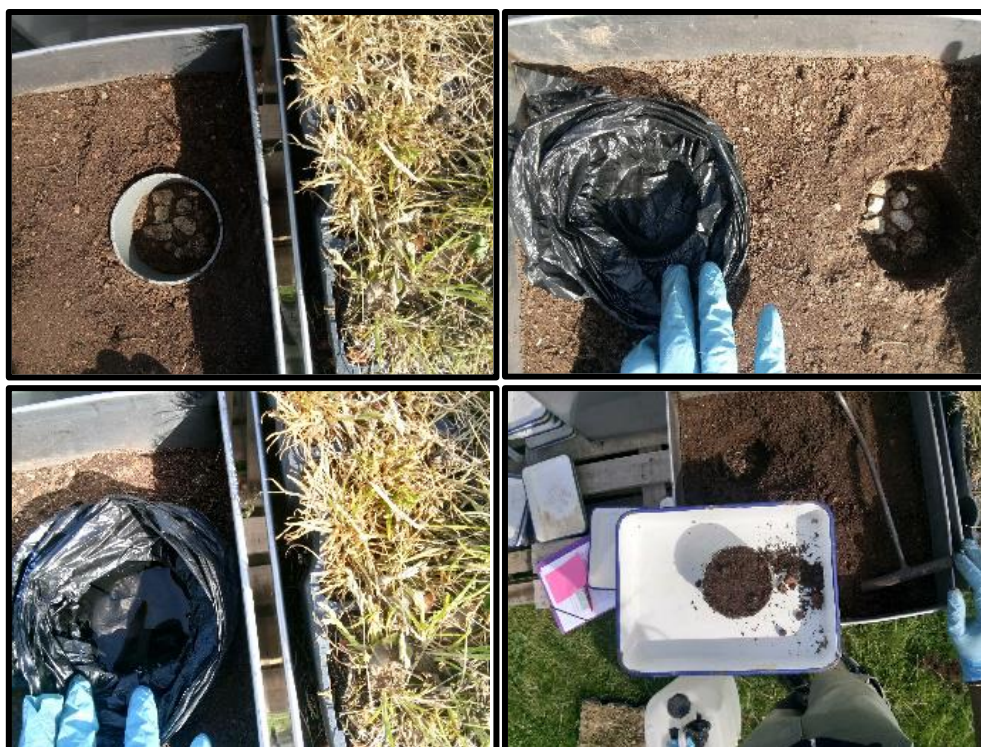
Figure 154 : Photos des différentes étapes de mesure de la densité apparente. Exemple de la mesure sur le lit de pose d'une colonne.
