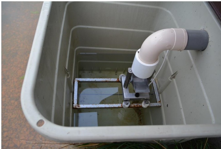
Figure II.26: Sortie de drain et débitmètre à augets de 130 ml du parking ECOMINERAL® à Broué
