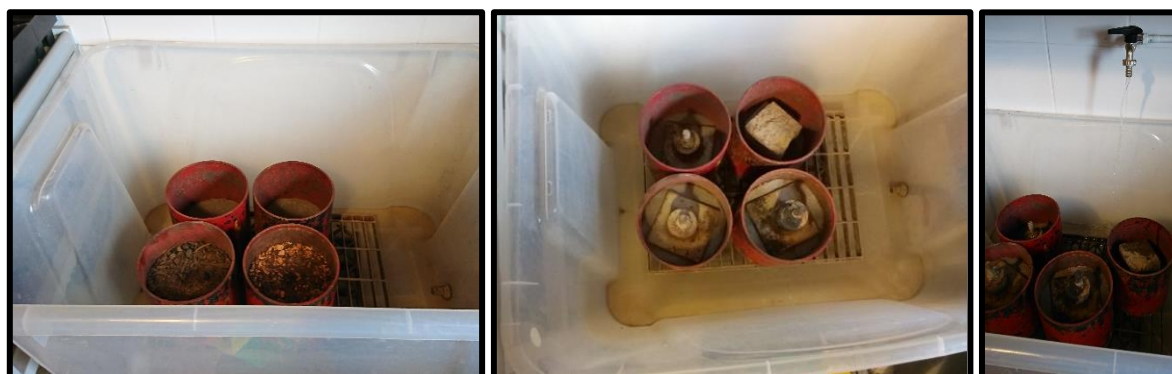
Figure 155 : Photo montrant la saturation des échantillons pour la mesure de la CME
