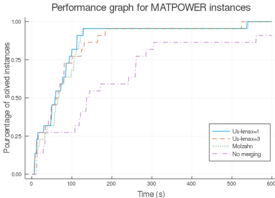
Figure 4.9 Graphe de performance pour les instances MATPOWER de plus de 1000 nœuds (excepté ACTIVSG25k) pour quatre stratégies : la nôtre avec  $k_{max} = 1$  et  $k_{max} = 3$ , celle dans [1] et pas de fusion de cliques.
