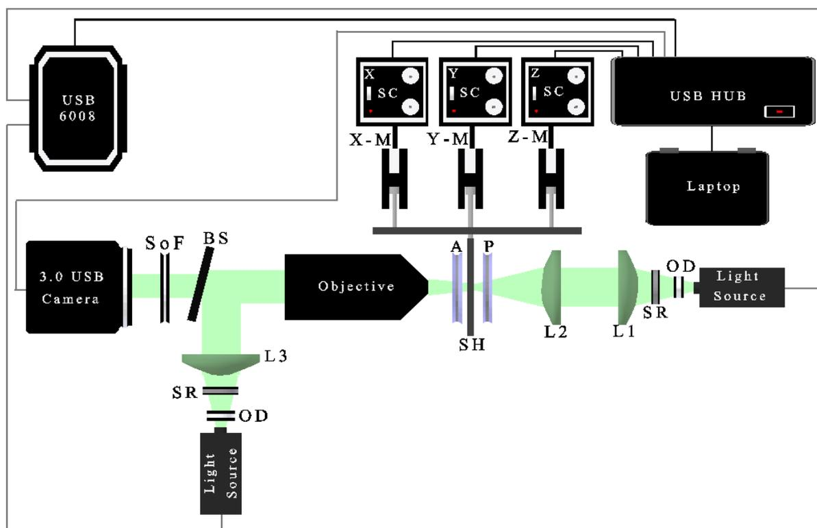
Figure 3. 16 : microscope optique 2<sup>ème</sup> version ; extrait de [24]
