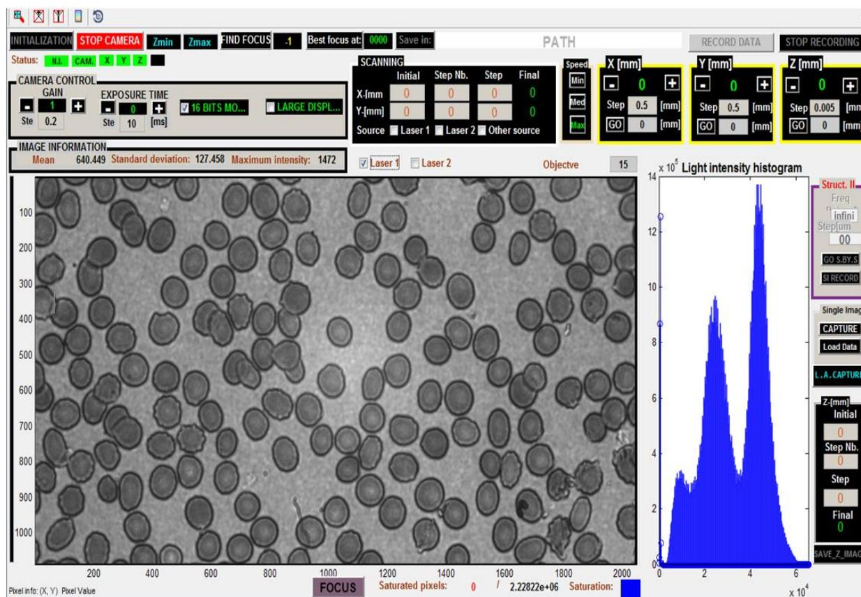
Figure 3. 19 : interface graphique de l'application de contrôle du microscope optique (2<sup>ème</sup> version) à illumination laser
