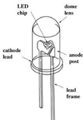
Figure 3. 10 : structure d'une DEL ; extraite de [162]
