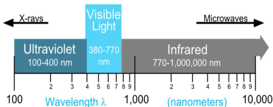
Figure 3. 2 : portion optique du spectre électromagnétique ; extraite de [139]
