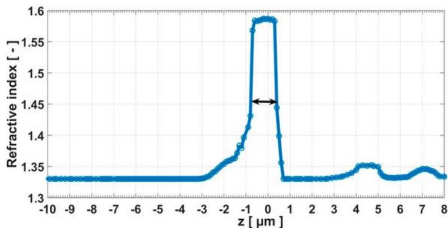
Figure 7. 8 : tracé des valeurs moyennes des indices de réfraction du spécimen en fonction des positions  $z$  ; extrait de [15]
