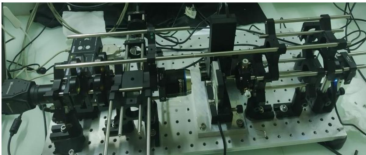
*Figure 3. 18 : schéma réel du microscope optique (2<sup>ième</sup> version) à illumination laser*
