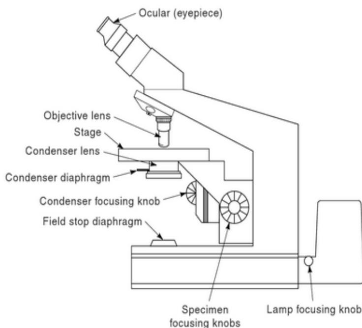
Figure 3. 14 : microscope optique standard ; extrait de [167]
