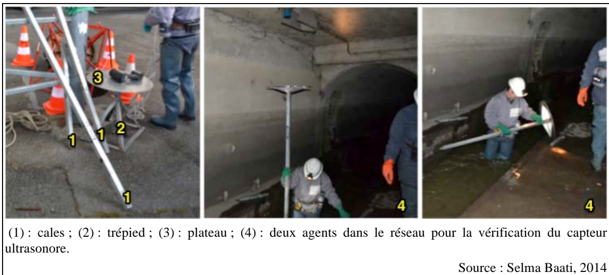
Figure 24 : Le système de vérification des capteurs ultrasonores – Métropole de Lyon
