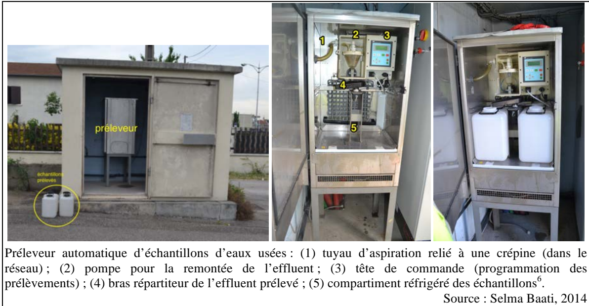
Figure 3 : Exemple de dispositif de prélèvement d'échantillons d'eaux usées en réseau d'assainissement
