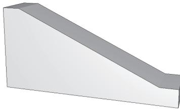
FIGURE 3.7 – Éprouvette pour essai Wedge. [Dieter, 1996]
