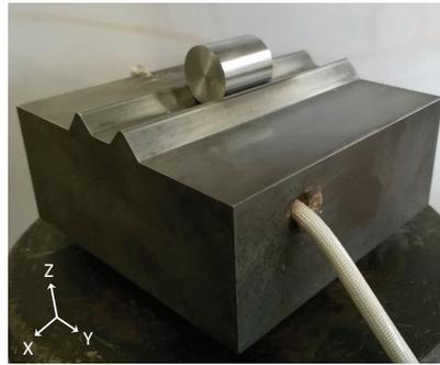
FIGURE 3.9 – Photographie d'une éprouvette positionnée sur la matrice inférieure TEFF.
