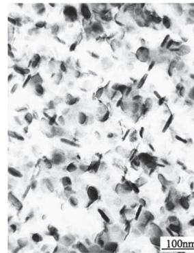
(d) Germination et croissance, Cu-3.2Ni-0.75Si-0.3Zn 550 °C 480 min. [Zhao et al., 2003a]
