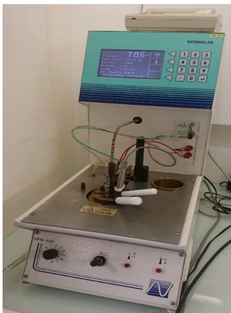
Fig.II.9 : Appareil de mesure du point d'éclair "Pensky Martens"
