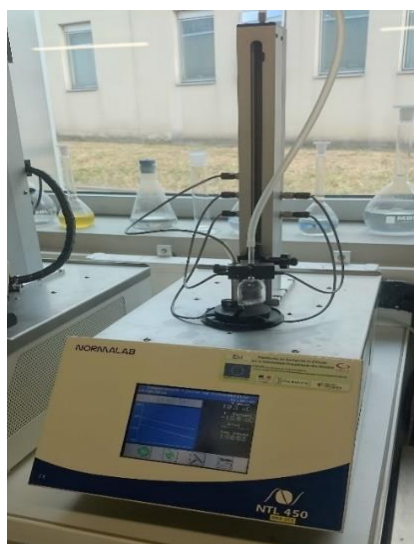
Fig.II.10 : Appareil de mesure de la température limite de filtrabilité
