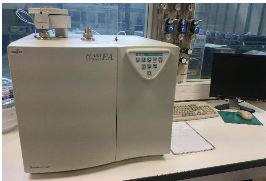
Fig.II.12 : Analyse élémentaire CHNOS
