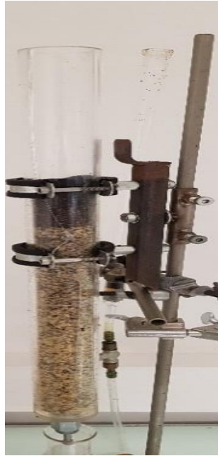
Fig.III.15 : Dispositif utilisé pour l'élimination du catalyseur dans le biodiesel.
