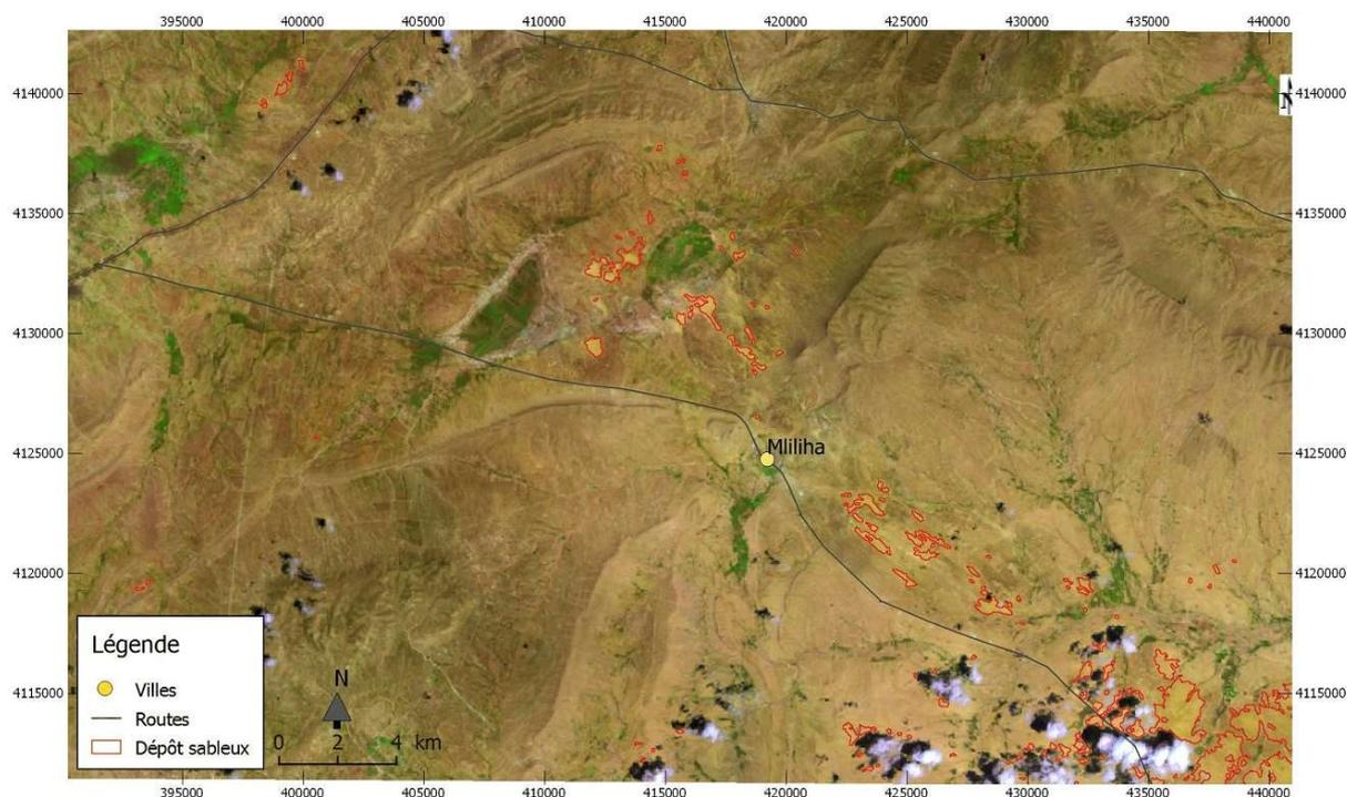
Figure 118 : Carte d'état de la surface d'ensablement en avril 2011, délimitation du sable sur l'image en composition colorée 5-4-1 (image ETM+, indice de Kappa=0.92, surface ensablée = 17 km<sup>2</sup>). Présence de quelques nuages sur les bordures sud-est, qui ont impacté les mesures à la baisse.
