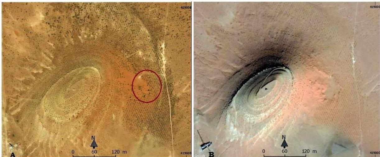
Figure 170 : Projet de mise en défense et fixation du sable, situé sur la zone de passage sédimentaire. L'Image (A) indique l'état des plantes avant la réactivation du processus d'ensablement. Sur l'image (B), on observe une fine pellicule de sable couvrant les plantes en souffrance (Image GeoEye, 34°43'29"N- 3°45'45"E). L'ellipse rouge indique le lieu de la photo précédente Figure 169.
