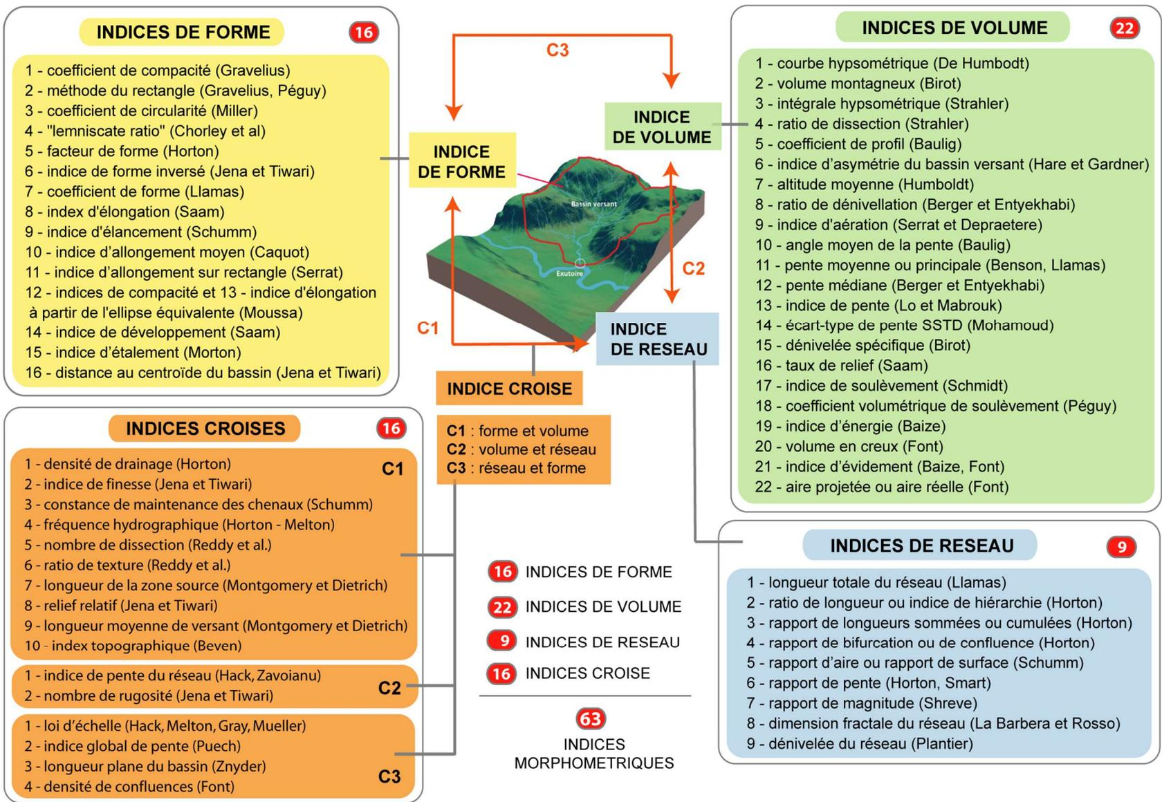
Figure 81 : Catégorie des indices morphométriques en hydrologie (Delahaye, 2005)
