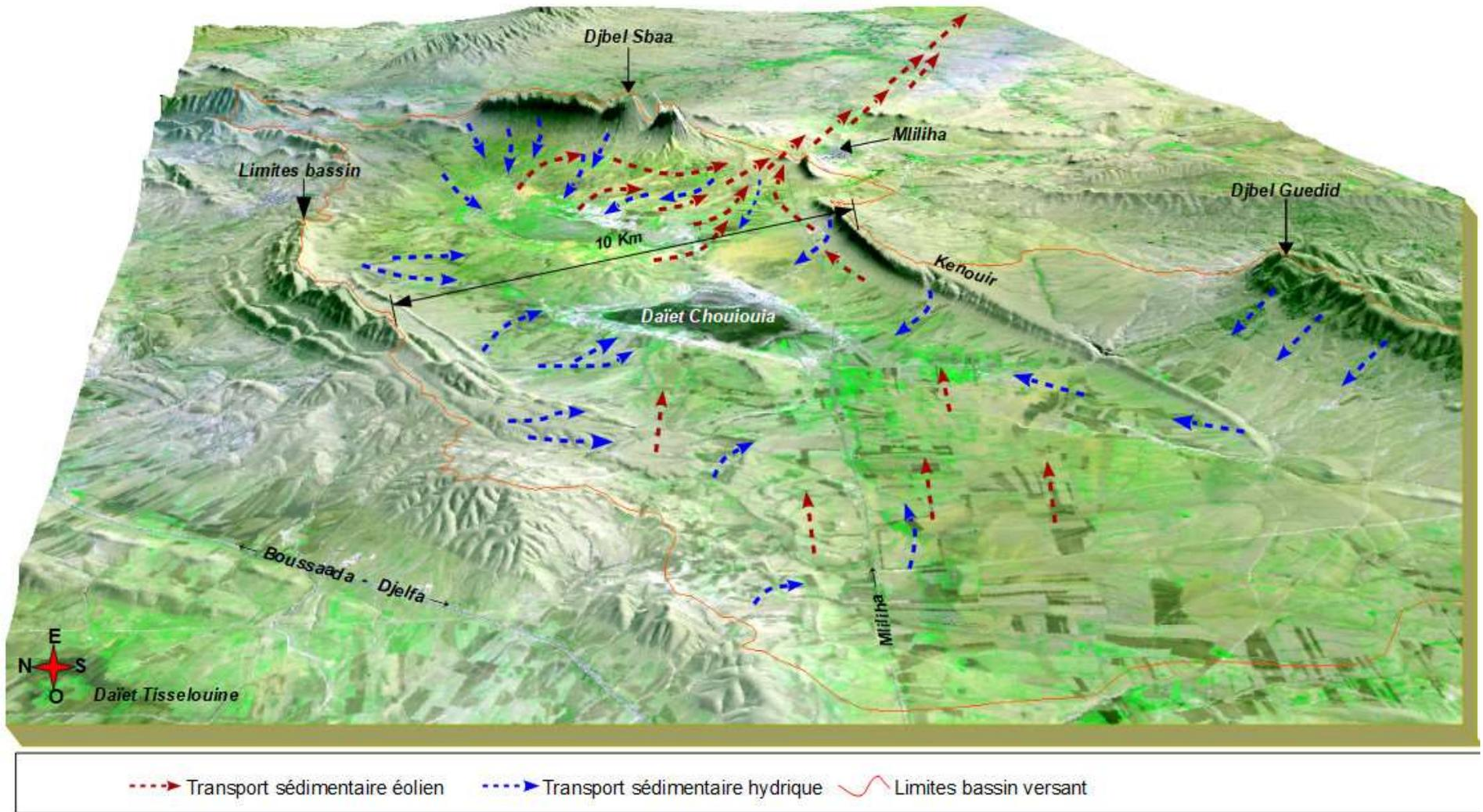
Figure 144 : Processus de transfert et d'interaction des flux sédimentaires éoliens, hydriques et de recyclage dans le bassin de Daiet Chouiouia, présentés sur une vue perspective 3D. MNT de précision 10 mètres et composition colorée (canaux 4,8,2) d'image Sentinel-2 du 28 décembre 2016.
