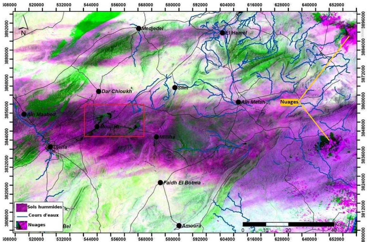
Figure 63 : Carte d'humidité du sol après le passage d'un orage à l'Est de Djelfa, composition colorée RGB 4-5-3 image satellitaire Landsat 7 <sup>ETM+</sup> prise le 17/07/2002 (sol humide en couleur mauve). Cette combinaison démontre les différences d'humidité du sol en fonction des capacités d'absorption de l'infrarouge par l'eau. Le rectangle rouge est la zone étudiée Figure 64
