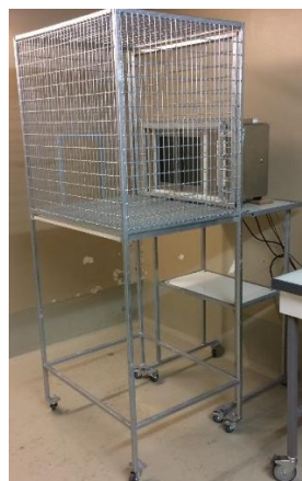
Figure 78 : Cage de travail positionnée devant le CANTAB dans le box de comportement. La cage de travail dispose d'une petite porte guillotine permettant le passage de l'animal depuis sa cage d'hébergement, ainsi que d'une deuxième ouverture aux dimensions du CANTAB, permettant de mettre l'animal en contact avec l'écran tactile.
