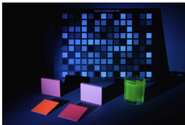
FIGURE 1.31 – Photographie d'objets fluorescents et non-fluorescents éclairés par une source monochrome bleue à 400nm. [MFW18]
