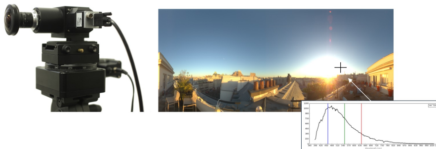
FIGURE 4.5 – Dispositif de capture d'environnements lumineux en mode spectral (à gauche). Vue équirectangulaire RGB d'une capture et reproduction du spectre d'un pixel (à droite).
