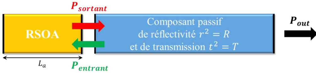
Fig. 121 : Schéma bloc d'un laser hybride constitué d'un RSOA parfaitement couplé à un composant passif de réflectivité R et de transmission T .
