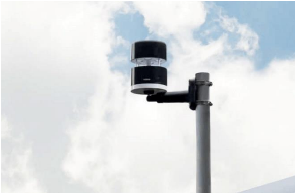
Figure 81. Dispositif de mesure fixé sur un support rigide à 2 m au-dessus du toit.
