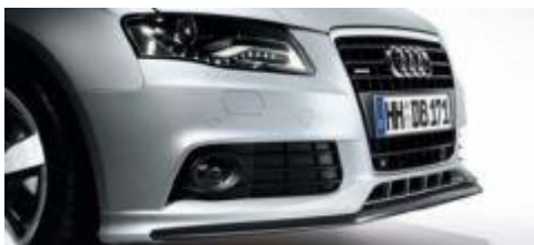
Figure 240 Exemples de lames DTM sur l'avant d'une voiture
