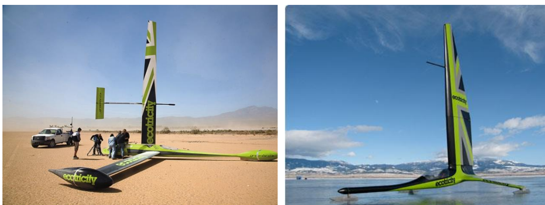
Figure 234. Le Greenbird, voiture propulsée par le vent bat le record de vitesse dans le désert du Nevada à 201\text{ km/h} , piloté par l'anglais Richard Jenkins. Il utilise aussi une voile rigide en carbone de type Foil pour atteindre 3 à 5 fois la vitesse du vent.
