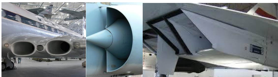
Figure 227 Exemples de prise d'air sur le fuselage d'un avion à réaction
