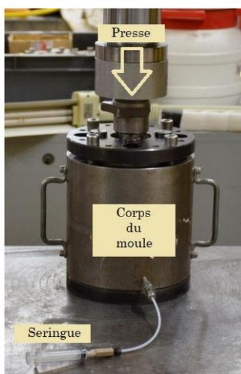
Figure 2 -3 : Poste d'extraction de la solution porale.
