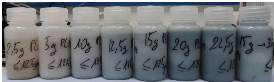
Figure 4-11 : Aspect visuel des solutions alcalines après une semaine de contact avec différentes quantités de laitier activé hydraté.
