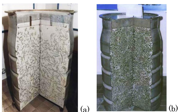
Figure 1-2 : Exemples d'immobilisations cimentaires de déchets nucléaires métalliques : (a) déchets magnésiens provenant de la filière nucléaire anglaise MAGNOX et (b) alliages de zirconium issus de la filière nucléaire américaine [20].
