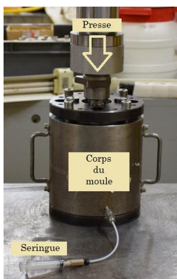
Figure 2 -3 : Poste d'extraction de la solution porale.
