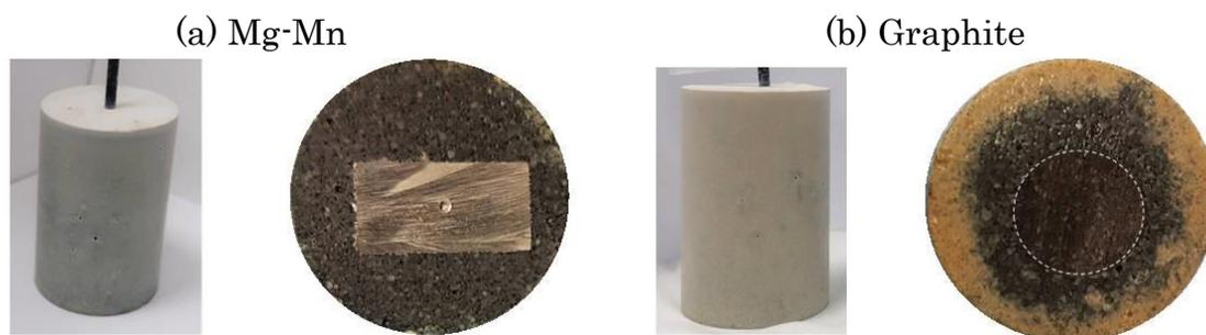
Figure 4-19 : Photos des échantillons de (a) Mg-Mn et (b) graphite après 28 jours de couplage galvanique en milieu aéré.
