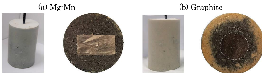
Figure 4-19 : Photos des échantillons de (a) Mg-Mn et (b) graphite après 28 jours de couplage galvanique en milieu aéré.
