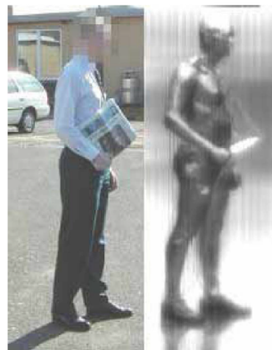
FIGURE 1.8 – L'image de droite est réalisée en imagerie passive à 94 GHz, alors que celle de gauche est une photographie en lumière visible. Par convention, les températures « froides » sont souvent représentées en blanc en imagerie sub-THz. Extrait de [20, 19].
