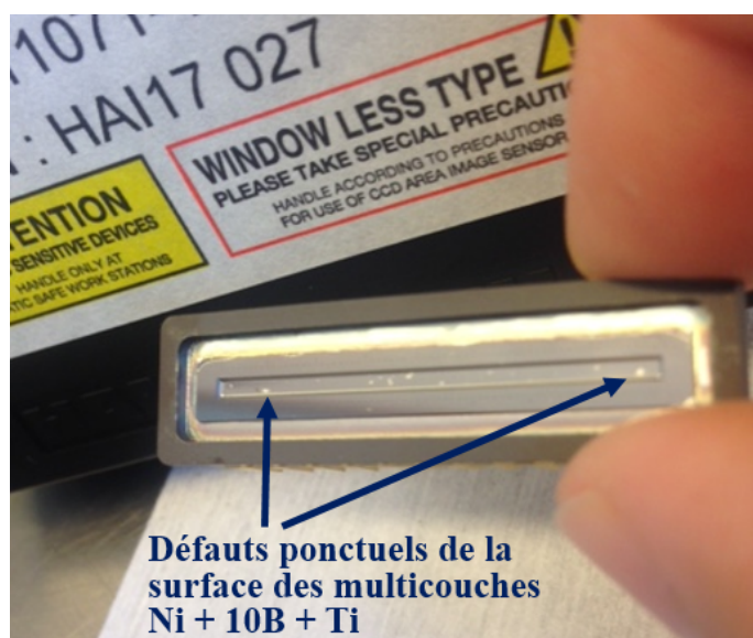
FIGURE 4.25 – Le CCD 027 après le dépôt B0011. Quelques défauts ponctuels de couleur blanche sont visibles.
