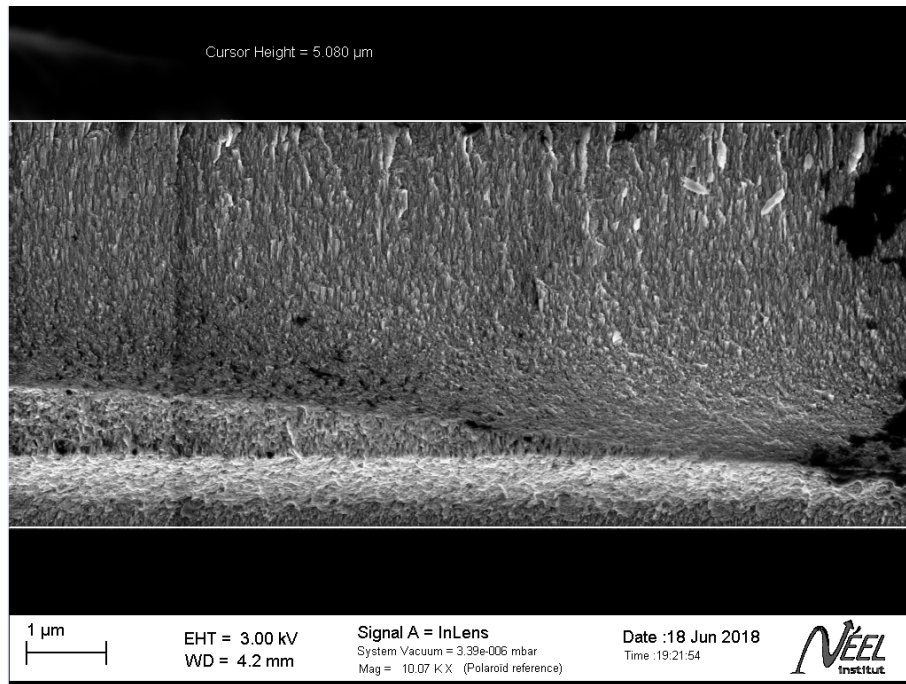
FIGURE 4.9 – Image de la section de l'échantillon ZnS0032, détecteur InLens.
