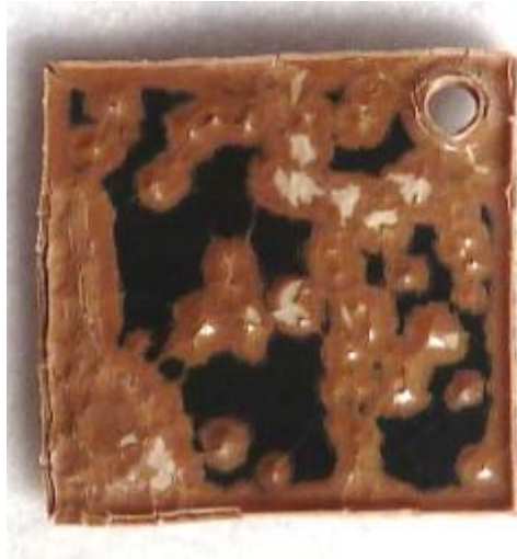
Figure C.1 : Photographie d'échantillon vierge oxydé sous air à 850 °C, pendant 4h15. Montée en température et isotherme sous air.
