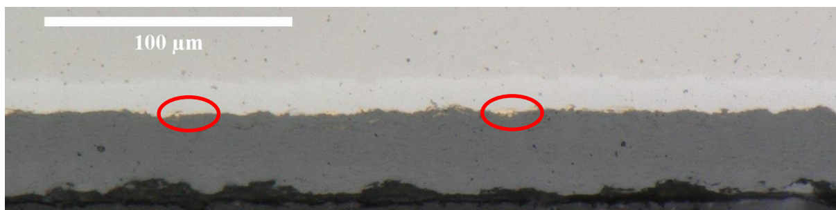
Figure 3.10 : Image en microscopie optique au centre de la plaquette après 26 min sous condition 3 (vapeur d'eau, oxygène, azote) et à 850 °C.
